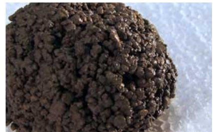
Bindemittel-/ Wasserfilm auf der Oberfläche des Schneeballs bei optimaler Konsistenz
