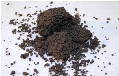
Zerfallener „Schneeball“ bei zu trockener Konsistenz
