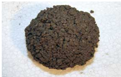
„Schneeball“ bei optimaler erdfeuchter Konsistenz
