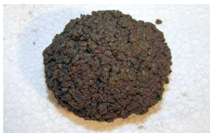
„Schneeball“ bei optimaler erdfeuchter Konsistenz
