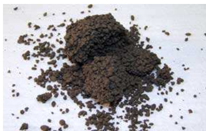
Zerfallener „Schneeball“ bei zu trockener Konsistenz
