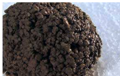
Bindemittel-/ Wasserfilm auf der Oberfläche des Schneeballs bei optimaler Konsistenz
